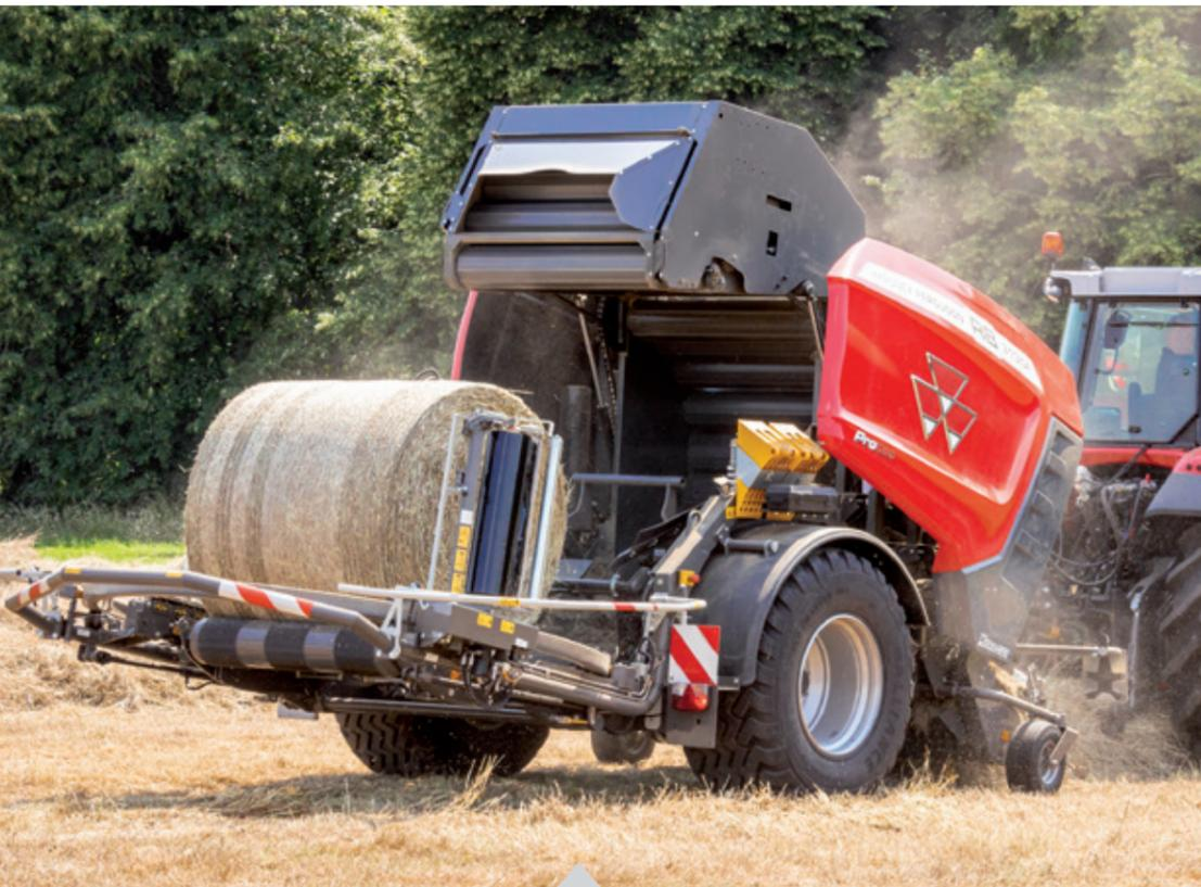
Unsere Press-Wickel-Kombi weist einen sehr flachen Winkel des Gutstroms auf, was zu einer niedrigen Gesamthöhe der Presse führt. Dies sorgt für Fahrstabilität und einen sicheren und schnellen Einsatz an Hängen. Darüber hinaus wird auch der Gegendruck im Zuführbereich reduziert, was den Materialfluss optimiert und das Risiko einer Blockade minimiert.
