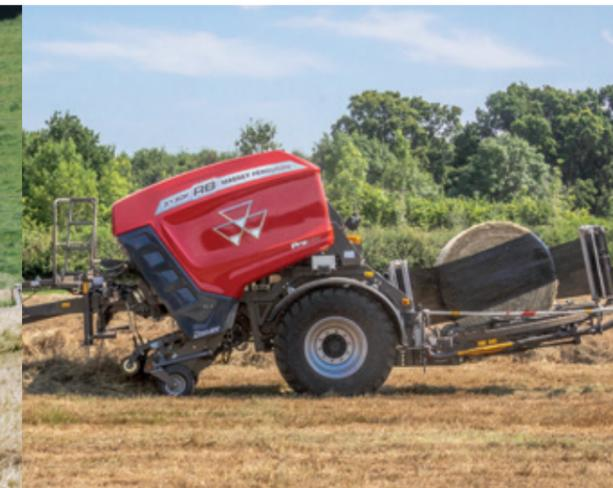
Für eine sanfte Ballenablage wird der Wickeltisch weit abgesenkt, was die Rotationsgeschwindigkeit des Ballens minimiert, eine Beschädigung der Folie verhindert und für eine gute Ballenform sorgt. Der optionale Ballenkipper bzw. Ballenaufsteller dreht die Ballen auf die flache Seite, verhindert so ein Wegrollen und erleichtert das Aufnehmen der Ballen bei der Verladung. Der Fahrer kann zudem zwischen einem automatischen und einem manuellen Entlademodus wählen.
