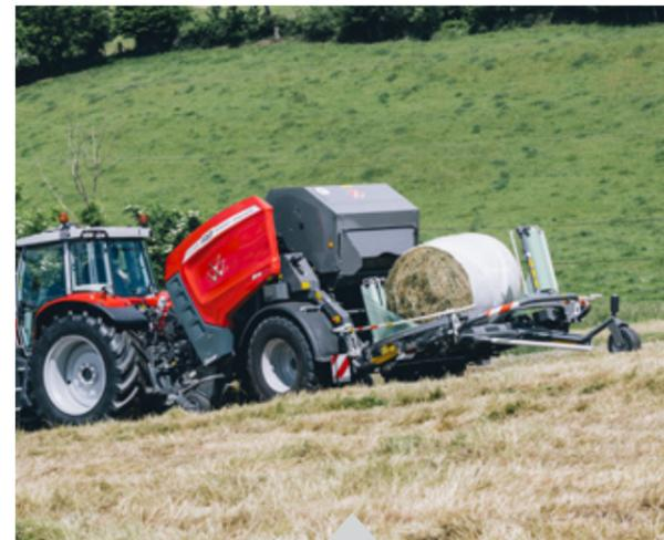
Sobald der Ballen in die Mitte des Wickeltisches befördert wurde, beginnt der hydraulisch angetriebene Wickelring zu rotieren, noch bevor die Heckklappe vollständig geschlossen ist. So ist der Zyklus abgeschlossen lange bevor der nächste Ballen geformt ist. Der robuste Rahmen ist auf extreme Lasten ausgelegt und der ruhig laufende hydraulische Antrieb mit bis zu 35 U/min sorgt für einen störungsfreien Wickelvorgang – und das Ballen für Ballen.
