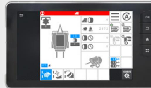
Sowohl die MF RB 3130 F Xtra Ballenpresse als auch die MF RB 3130 F Protec Press-Wickel-Kombinationen können mit direkter ISOBUS-Verbindung ausgestattet werden, wobei das Traktorterminal als Anzeige genutzt wird.
