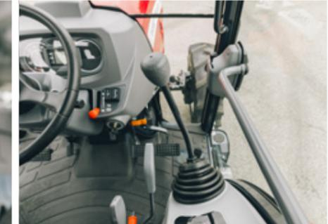
Mehr Komfort dank der schwenkbaren Lenksäule und des rechtsseitig montierten hydraulischen Joysticks zur einfachen und präzisen Steuerung von Anbaugeräten
