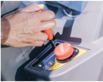
Gut positionierter Handgashebel
