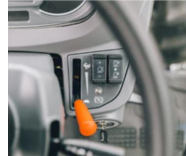
Praktische Bedienelemente zur Einstellung der Motordrehzahl
