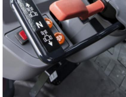
Für Modelle der Baureihe MF 1700 M: elektrohydraulischer Schalthebel für zusätzlichen Komfort
