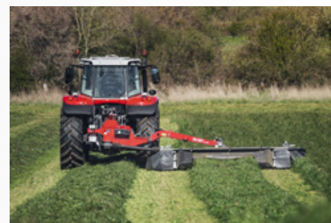
Mähbalken mit flachem Profil und Stirnradantrieb
