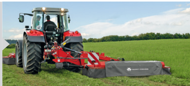
Heckanbau-Trommelmähwerk mit Mittenaufhängung
