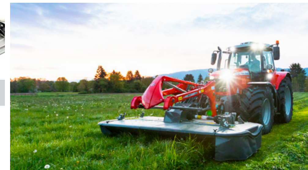
Mähbalken mit flachem Profil und Stirnradantrieb
